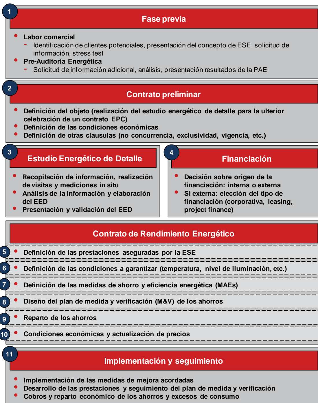
Figura 2. Elementos clave en un proyecto de servicios energéticos con garantía de ahorro
